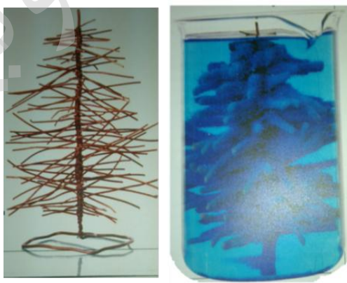
شکل ۲. با قرار دادن سیم مسی (درختچه مسی) در محلول نقره نترات رنگ محلول تغییر می‌کند.
